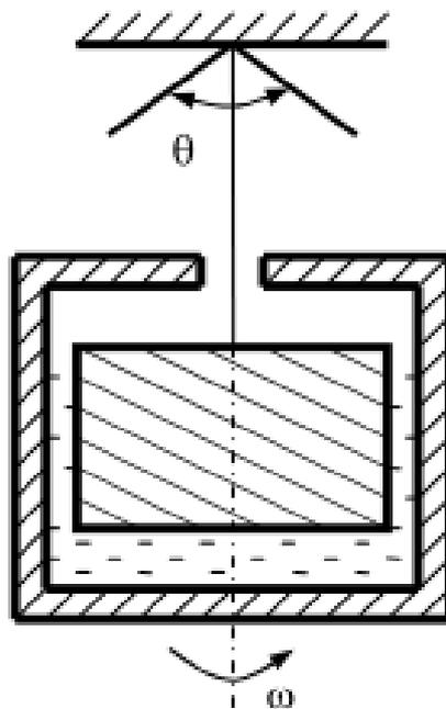
Внутренний цилиндр подвешен на нити, а внешний может вращаться вокруг своей продольной оси с регулируемой угловой скоростью  $\omega$ . Зазор между цилиндрами заполняется исследуемой жидкостью, в частности, кровью.
